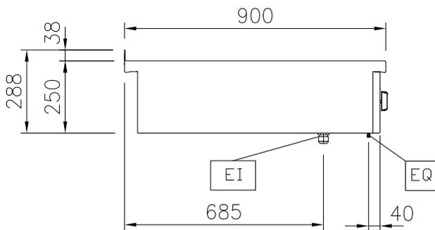
EI = Conexión eléctrica (energía)
